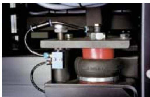
Un exclusivo sistema de suspensión neumática de cuatro puntos asegura una filmación precisa.
